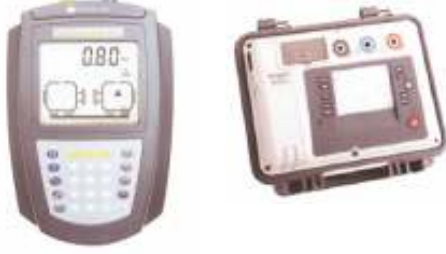
İZOLASYON(MEGER) ÖLÇÜMÜ, DAR VE POLARİZASYON İNDEKSİ HESABI INSULATION (MEGER) MEASUREMENT, CALCULATION OF DAR OR POLARIZATION INDEX
